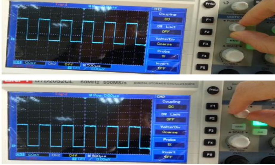
Şekil.21 Düşey ekran pozisyon kontrolü
