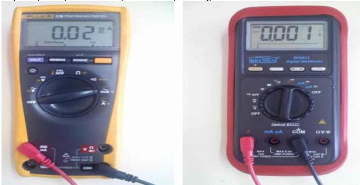
Şekil.10 DC mili-amper ve DC amper ölçümü için hazırlanmış multimetreler
