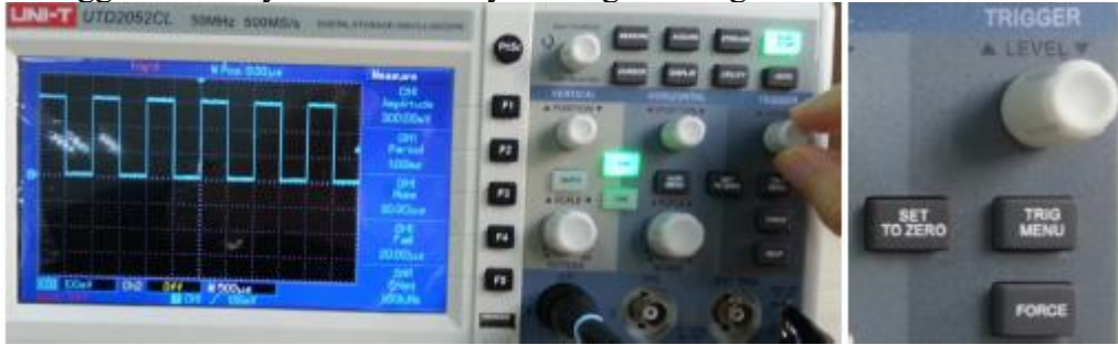
Şekil.29 Osiloskop trigger görüntüsü
