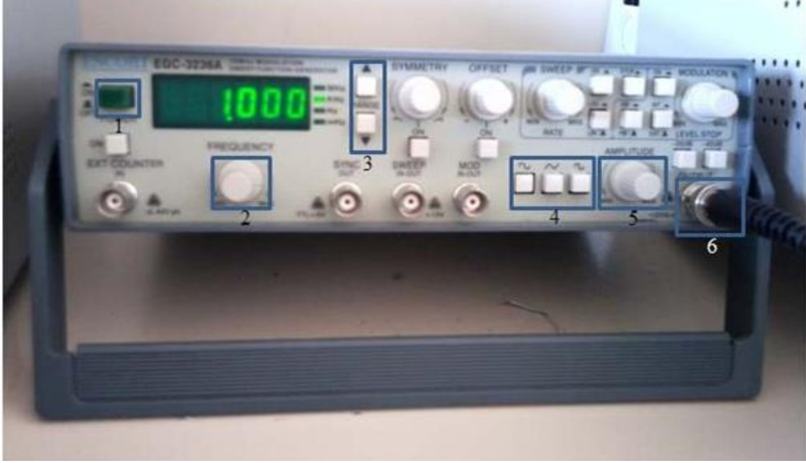
Şekil.12 –Elektrik devre laboratuvarında kullanılan sinyal üretici.
